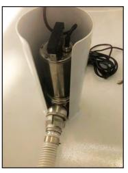
Pumpe auf der Oberseite des Tanks durch einen halbstarren PVC-Schlauch verbunden
