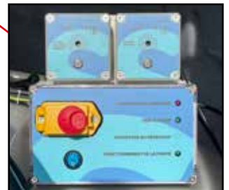
Kontrollkasten mit Hauptschalter, Leckagesensor und Höchststandsensor
