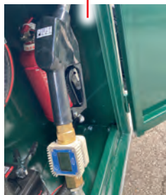
Automatische Pistole mit digitalem Volumenzähler
