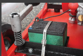
Batterie 12 V pour le démarrage électrique du moteur
