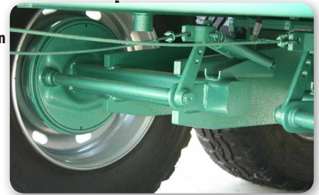
Hydraulisches Bremsen auf den 4 Hinterrädern
