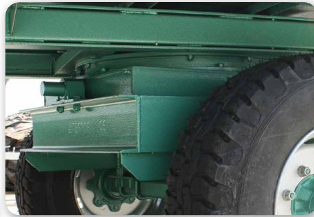
Drehschemel mit Pendelachse
