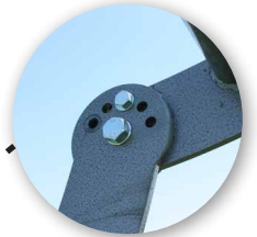
Einstellbare Rundballenleitern, ermöglicht ein Zusammenklappen bei Leerfahrten
