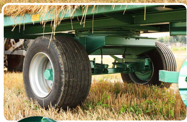
Drehschemel mit Pendelachse
