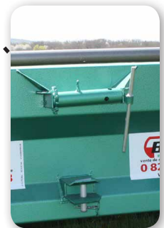
Handwinde und Hacken für 2. Anhänger
