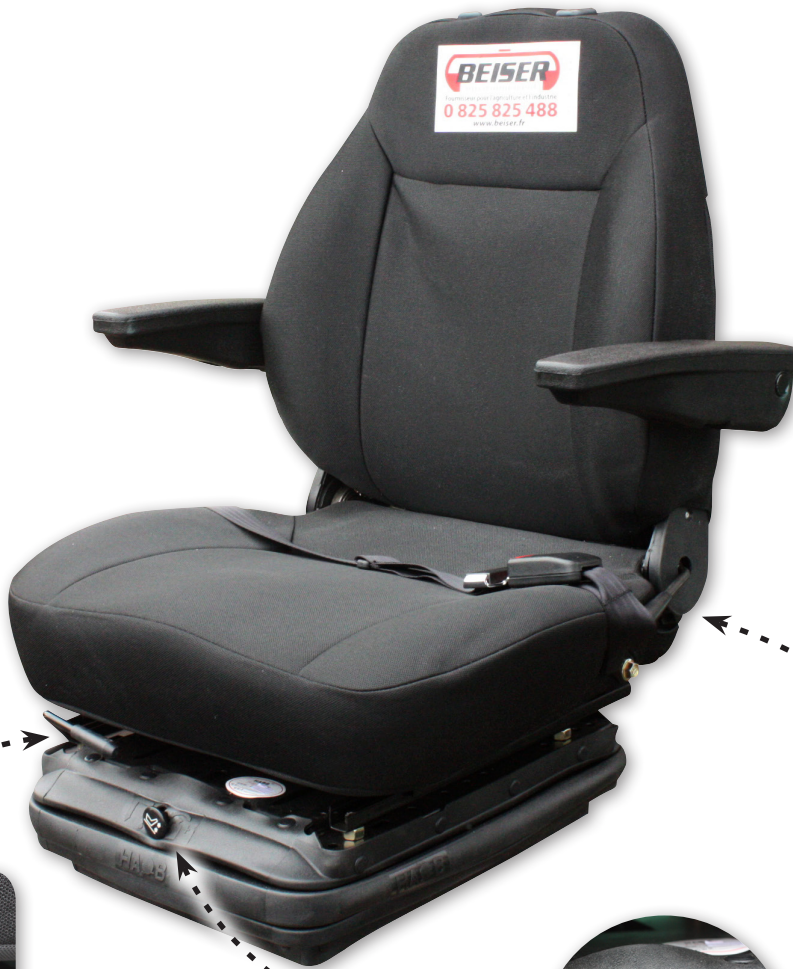
Hebel für die Tiefeneinstellung
