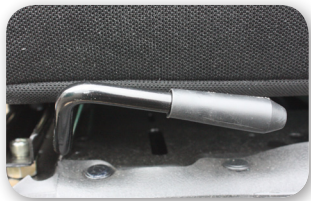
Hebel für die Tiefeneinstellung
