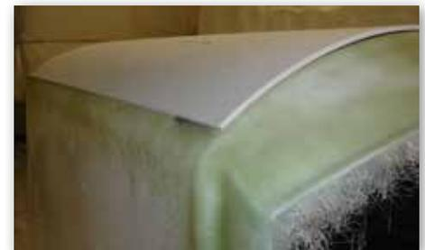
Isolation aus Polyurethan-Schaum (Dicke 10 mm) zwischen zwei Polyesterschichten
