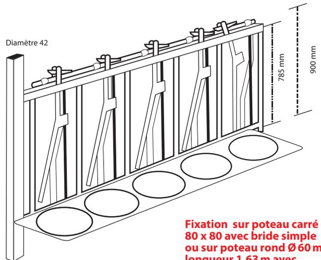
Fixation sur poteau carré 80 x 80 avec bride simple ou sur poteau rond Ø 60 mm, longueur 1,63 m avec brides soudées
