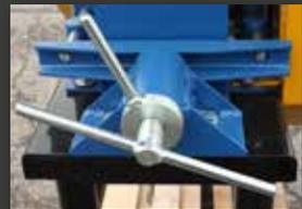
Spann- und Dämpfungsschraube
