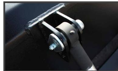
> Haltestifte (Ø30 mm) für Zylinder mit verschraubten Verstärkungen + Schmierern
