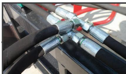
Hydraulisches T Verbindungsstück
