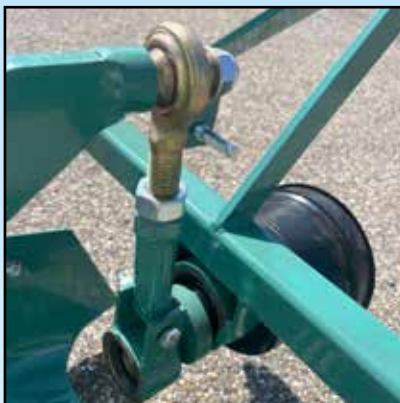
Kolben der Kardanwelle, der die Vibrationen verursacht
