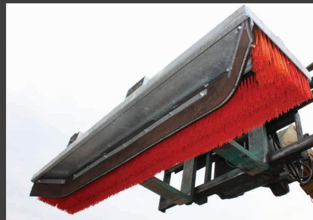
Schiebe Gummi und Bürste mit Kanten : Damit das Zusammengekehrte nicht über die Seiten läuft
