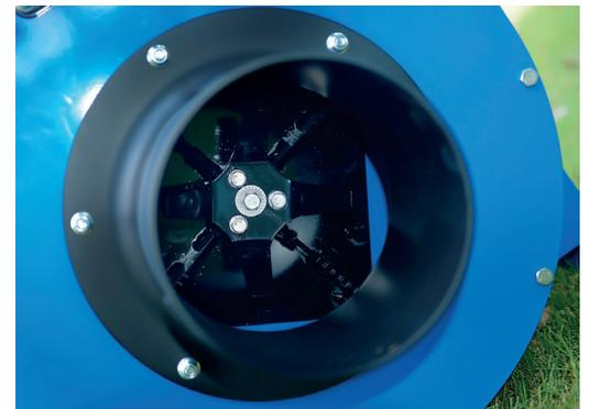
Auslass für die Abzweigung des Saugrohres
