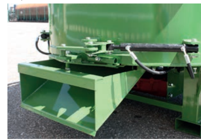
> 3 Abflussluken mit hydraulischer Öffnung
