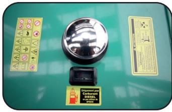
Kraftstofftank mit Füllstandsanzeige
