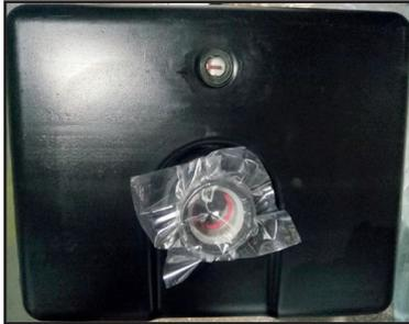
Kraftstofftank mit Füllstandsanzeige
