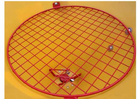
> Sicherheitsgitter und Rührwerk
