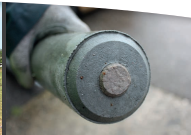
Metallarmierung ST 37 - Ø 26,9 x 2 mm
