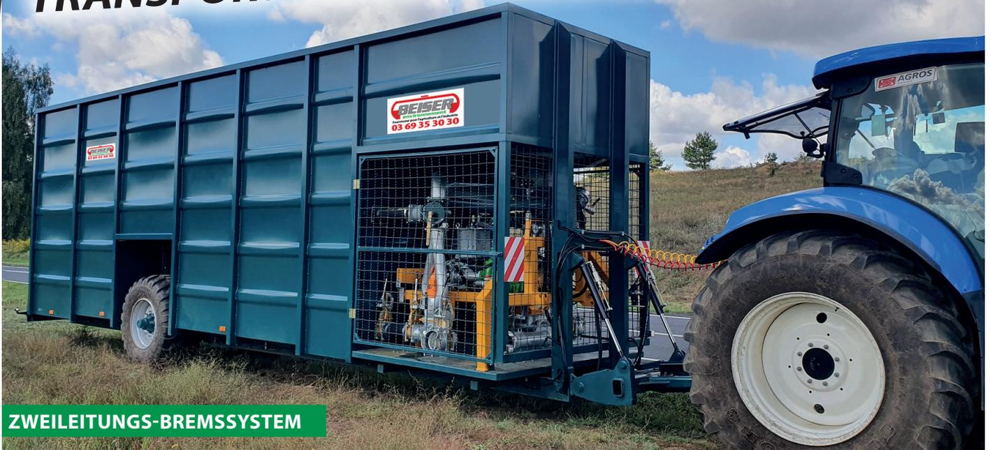
➔ **Der Behälter wird als Zwischenlager für Gülleverteiler verwendet, die Jauche liefern, die einen Ausgleich zwischen der verfügbaren und der benötigten Menge an flüssigem organischem Dünger darstellt.**
