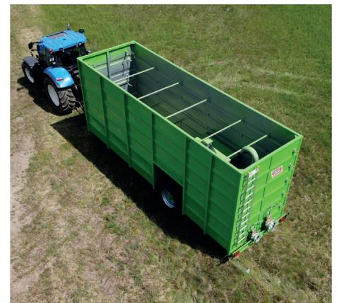
Der Behälter kann befüllt werden, indem das Fahrzeug über einen 6-Zoll-Saugschlauch an der Rückwand des Behälters angeschlossen wird.
